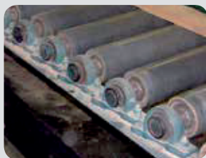
Přehřáté ložisko dopravníku
