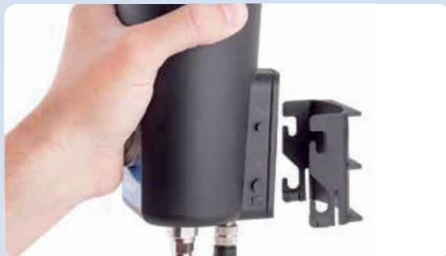
Speciální držák usnadňuje montáž TLMR na různé povrchy
